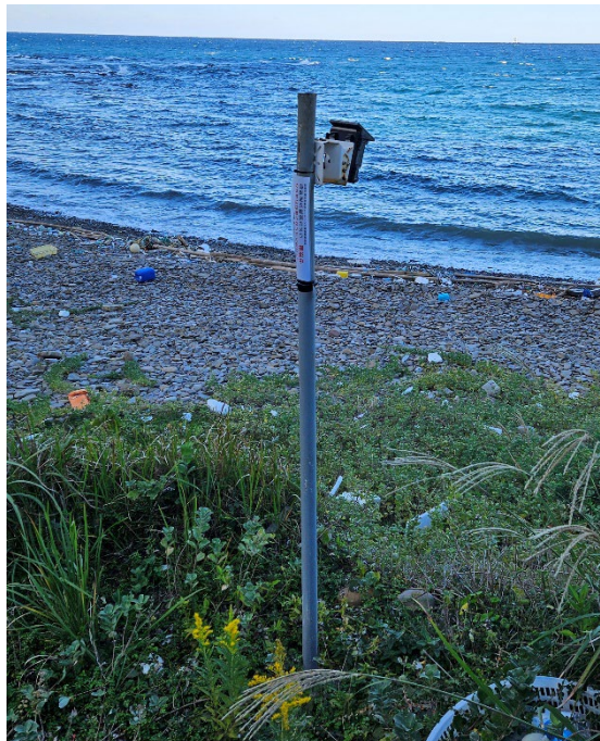
図 3-1. 定点観測カメラの設置状況
